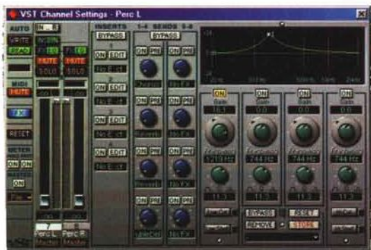
Cubase - Per ciascun canale audio in Cubase VST è possibile avere a disposizione un equalizzatore parametrico a quattro bande. Inoltre, ciascun canale ha quattro mandate effetto, che è possibile assegnare a quattro "processori effetto" interni per aggiungere riverbero, chorus ed altri effetti. Ci sono anche quattro effetti master, che sono inseriti nel bus di uscita del mixer.
